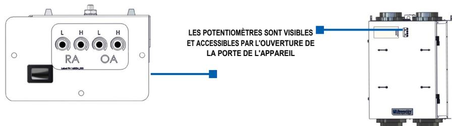
FIGURE 4.10.1 POTENTIOMÈTRES DE CONTRÔLE DE LA VITESSE DU VENTILATEUR
