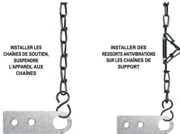
FIGURE 4.4.0 INSTALLATION DE LA CHAÎNE DE SOUTIEN
