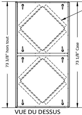
Filtres à placer en amont des noyaux, en fonction de la disposition des flux d'air choisie.
