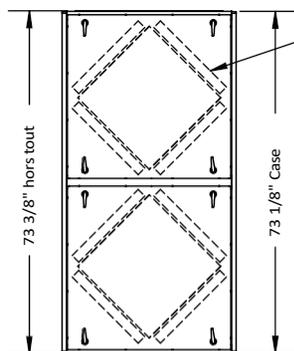
Filtres à placer en amont des noyaux, en fonction de la disposition des flux d'air choisie.
