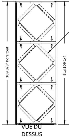
Filtres à placer en amont des noyaux, en fonction de la disposition des flux d'air choisie.
